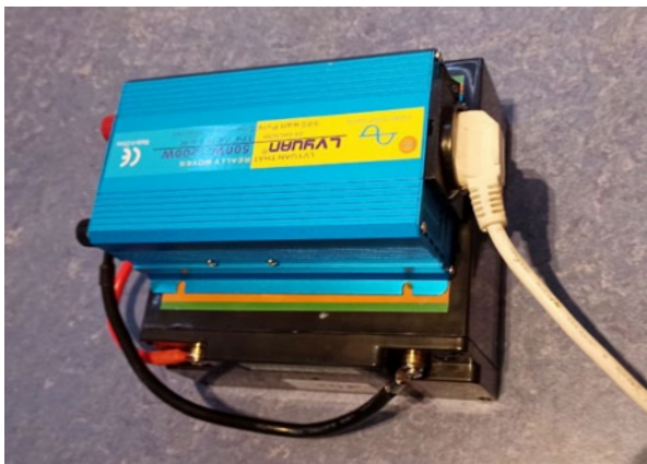
Für ein Inselkraftwerk braucht es nur wenige Teile: Akku, Wandler und ein Solar-Panel – schon hat man bis zu 0,6 kwh am Tag und noch mal 0,4 kwh in der Nacht.
